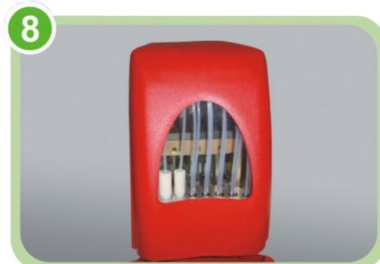
8 八步骤清洗塔自动对比色皿进行清洗, 比色皿经严格光学测试后投入下一次分析使用
