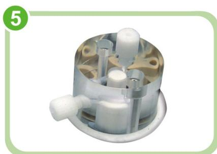
5 稀释器自动制作标准曲线, 并对超标样品稀释后重分析
