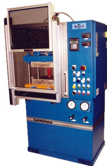
ASTM 标准塑料模压机
