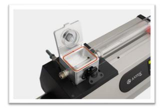
$$R - S + O_2 \xrightarrow{1050^{\circ}C} CO_2 + SO_2 + H_2O$$
